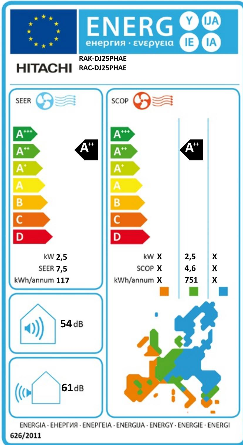
Dieses Label wird von dem "ErP Actice Tool", HITACHI Ecodesign Anwendung, erzeugt. Es bezieht sich auf den Anhang III der europäischen Verordnung (EU) Nr.626/2011 vom 04.05.2011 zusätzlich zu der Richtlinie 2010/30EU die sich mit der Kennzeichnung von Klimageräten befaßt.
